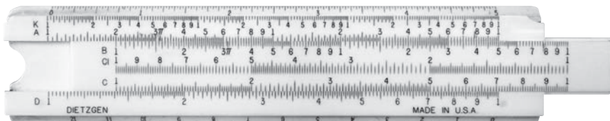
Rysunek 10.4. Obliczanie iloczynu 2X dokonane na suwaku logarytmicznym z wykorzystaniem tego, że \log(2X) = \log(2) + \log(X)
